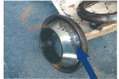
DST(Distress)값은 4에서 26으로 증가를 나타냈지만, FFT 진동은 이를 감지하지 못함.
