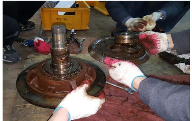
과거 B사 광유를 사용 하였으나 수분, 입자등의 극심한 오염으로 오일이 열화되고 바니쉬가 생성 되었음. 즉, 냉각탑 감속기의 가혹한 운전조건을 광유가 견디지 못하여 유막이 파손되고 금속간 접촉 (Metal to Contact)으로 기어박스가 파손되는 사례가 다수 발생 → 2015년 SYNFILM GT 220 으로 교체후 현재까지 관리중.
