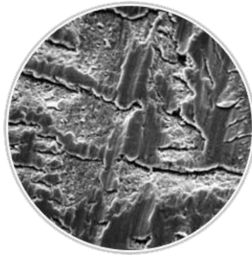
경쟁사 일반 합성유 사용후 동일 베어링 표면 1,500배 확대 촬영
